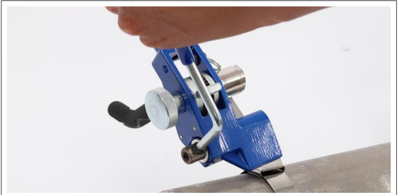
⑧ Schlagen Sie den Edelstahlgürtel mit einem Hammer in die Packschnalle und schlagen Sie dann mit einem Hammer auf die Ösen der Packschnalle auf beiden Seiten des Edelstahlgürtels, um die Packschnalle zu fixieren.
