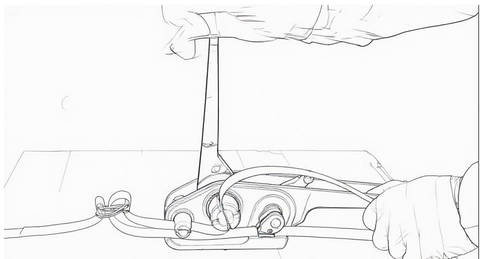
4. Drücken Sie mit der rechten Hand auf den Griff des Werkzeugs und nachdem Sie das Band abgeschnitten haben, drücken Sie das Werkzeug fest nach rechts, um es zu entfernen.
