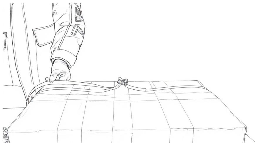
2. Legen Sie, wie im Bild gezeigt, das untere Packband unter die untere Zahnplatte und den Schneidkörper, und schieben Sie das obere Packband in die Schneidnut und die Spindelnut.
