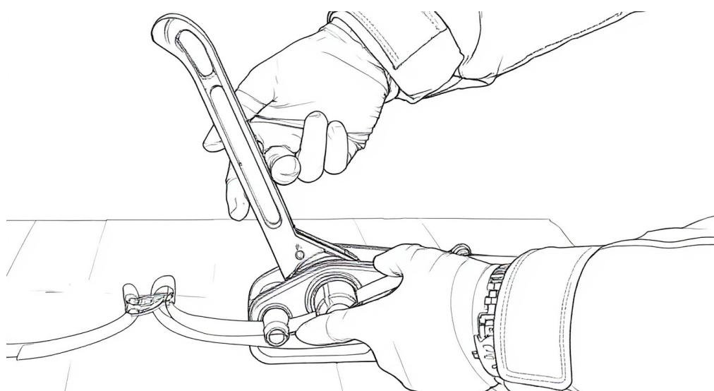
3. Während Sie das Werkzeug mit der linken Hand halten, schieben und ziehen Sie den Griff mit der rechten Hand vor und zurück, bis das Packband straff ist.
